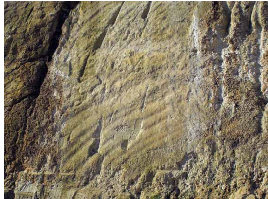
Foto 3.8 - I litotipi ascrivibili alla “Pietra Leccese” sono rappresentati da calcareniti organogene a grana medio-fine, più o meno marnose, di colore bianco-giallino o avana, a stratificazione indistinta.
